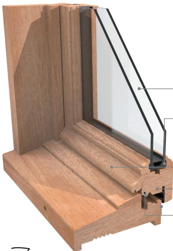
Double vitrage de 24 mm à isolation renforcée par une couche de faible émissivité et du gaz argon
