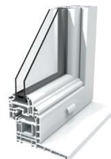
Double ou triple vitrage de 24 à 40 mm d'épaisseur à isolation thermique renforcée par une couche de faible émissivité, intercalaire Warm Edge
