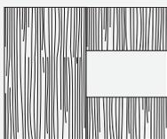
Dans le cas de vantaux partitionnés associés à un vantail 1 partition, le veinage sera vertical.
