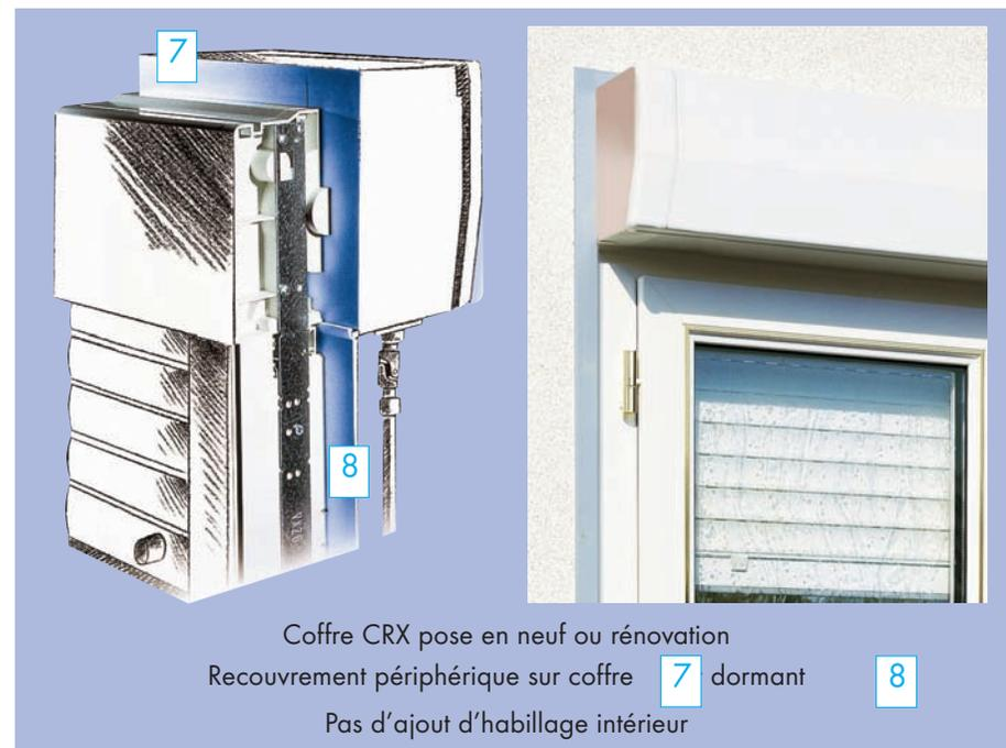
Coffre CRX pose en neuf ou rénovation
