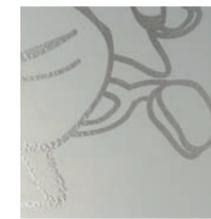
Procédé de dépolissage et de gravure du verre obtenu par projection puissante de sable suivant un modèle de pochoir. Convient à tous les styles, modernes et traditionnels.
