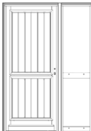
Porte d'entrée avec fixe latéral et traverse intermédiaire, pour rappeler l'esthétique du modèle de porte
